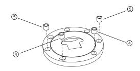
3. 将零件①放在铝套上(注意将孔位对齐),放入螺丝,并依次紧固螺丝。(零件②扭力:  $2N \cdot m$ 零件③扭力:  $5N \cdot m$ )
